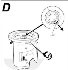
ナイロンスリーブソケット162の割目と電動機軸のキー溝位置を必ず合わせて下さいロックねじ134をポンプ本体401の穴に合わせて位置調整をして下さい。ロックねじ134を回転させて、電動機軸キー溝にはめ込んで下さい。
