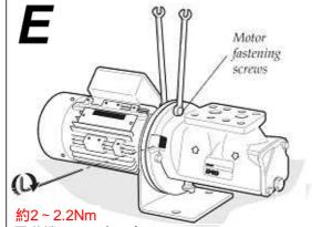
電動機とアングルブラケットをはめ、 ロックねじ134が電動機軸キー溝に入った事を 確認して下さい。
